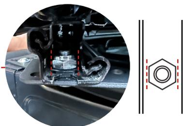
Falls eine manuelle Handbremse montiert ist, muss diese mittels Handbremshebeladapter (Art.Nr. 104707) tiefer gesetzt werden.
